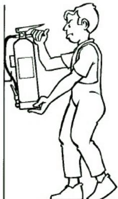
**2.- Asir la boquilla de la manguera del extintor y comprobar, en caso que exista, que la válvula o disco de seguridad (V) está en posición sin riesgo para el usuario. Sacar el pasador de seguridad tirando de su anilla.**
